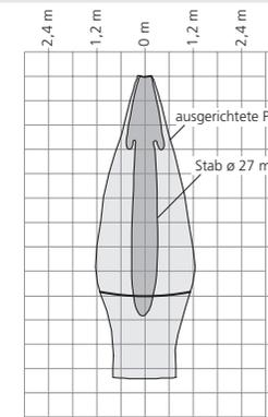
**Erfassungsbereiche** bei unterschiedlichen Objekten: Die dunkelgrauen Flächen geben den Bereich an, in dem der Normalreflektor (Stab) sicher erkannt wird. Dies ist der typische Arbeitsbereich der Sensoren. Die hellgrauen Flächen stellen den Bereich dar, in dem ein sehr großer Reflektor – wie z.B. eine sehr große Platte – noch erkannt wird – vorausgesetzt, sie ist optimal zum Sensor ausgerichtet. Außerhalb der hellgrauen Fläche ist keine Auswertung von Ultraschallreflexionen mehr möglich.
