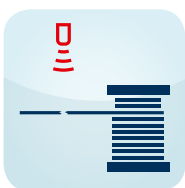
Détection de rupture de câble
