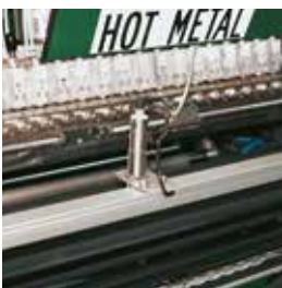
Contrôle du diamètre d'enroulement sur machine à stratifier
