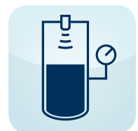
Füllstandmessung in 6 bar Überdruck
